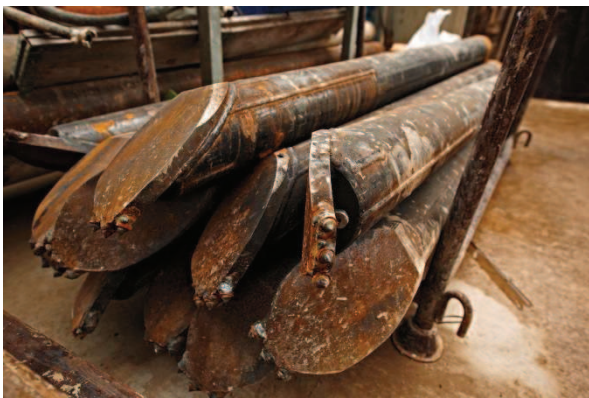
Bild 2: Bohrköpfe für gesteuerte Bohrungen bei der Baumaßnahme Wehrhahn-Linie, Düsseldorf
